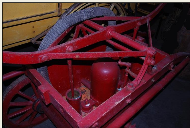
Vattenkar med pumputrustning i kärrsprutan ovan.
