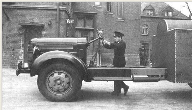
M4517 levererades med frontpump med färdigkopplad slang och Kometrör (skum).
