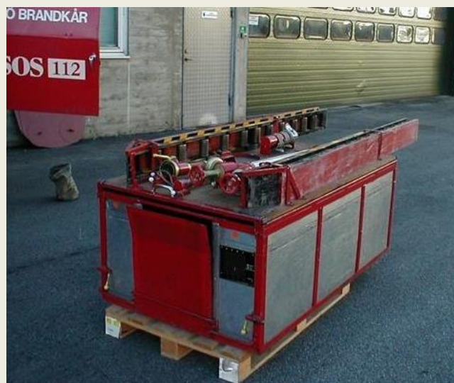
Slangkassetten lucka för slanguttag. Ovanpå finns lastningsgejderna, brandpost och brandpostnyckel. Kassetten rymmer 600 m 76 mm slang.
