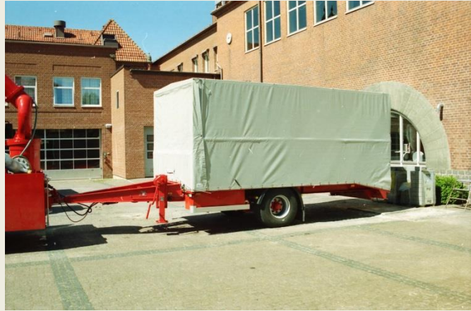
Släpvagnen är tillverkad av Härrydasläp. Det långa överhänget bakåt beror på att den koncentrerade vikten ligger långt fram på.
