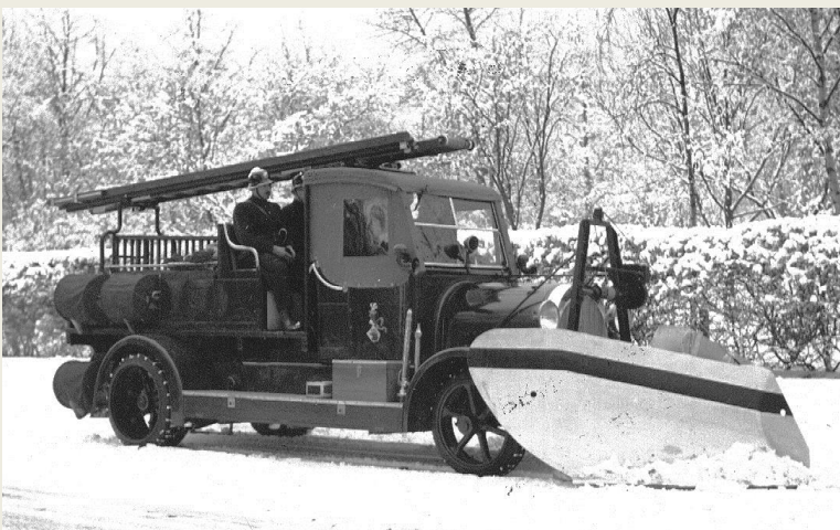
Under de snörika vintrarna på 40-talet monterades ett fäste för snöplog på bilen. Bilen stod mot slutet i depå på Bulltofta, där bilden nedan är tagen.
