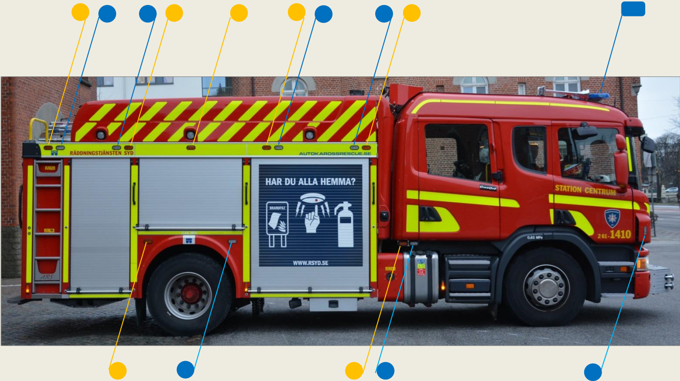
Totalt tjugo blåljuspunkter runtombilen kompletterar ljusrampen på taket. Alla av LED-typ. Dessutom finns tjugo liknande ljuspunkter fast med orangegult sken.
