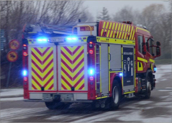
Totalt tjugo blåljuspunkter runtombilen kompletterar ljusrampen på taket. Alla av LED-typ. Dessutom finns tjugo liknande ljuspunkter fast med orangegult sken.
