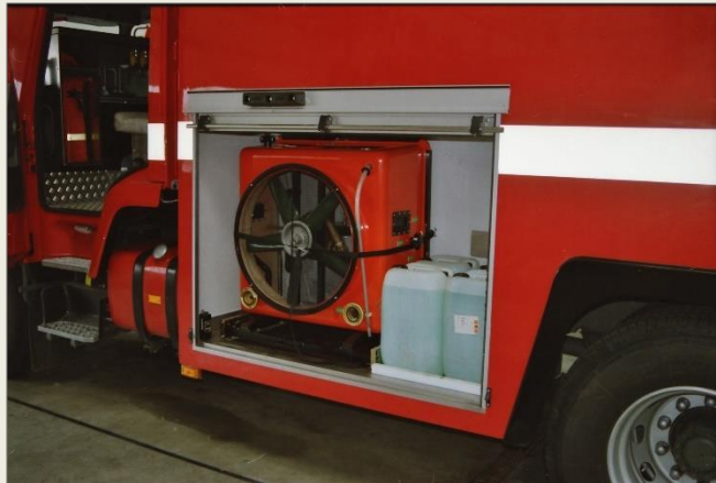
I facket på bilens vänstra sida finns lättskumaggregatet och skumvätska på dunk.
