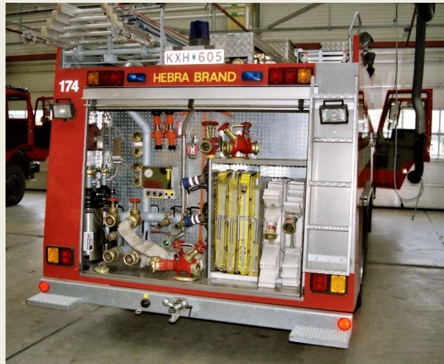
I bakre facket på skåpet finns Rubergspumpens manöverutrustning med sug- och tryckanslutningar för vatten och skum olika brandposthuvuden och andra armaturer samt strålrör och skumrör. I högra delen finns häckar med smal- och grovslang. På taket finns utskjutstege och skarvstegar samt förvaringsbox.
