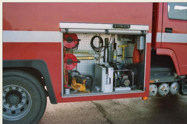
I facket på skåpets högra sida finns eldriven hydraulpump och olika verktyg.
