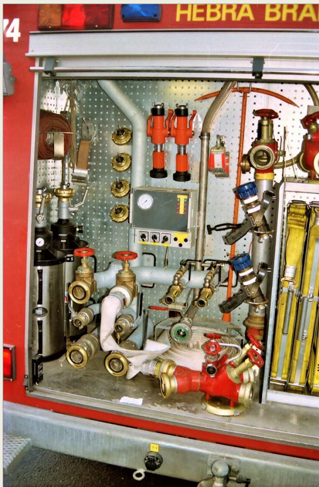
I bakre facket på skåpet finns Rubergspumpens manöverutrustning med sug- och tryckanslutningar för vatten och skum olika brandposthuvuden och andra armaturer samt strålrör och skumrör. I högra delen finns häckar med smal- och grovslang. På taket finns utskjutstege och skarvstegar samt förvaringsbox.
