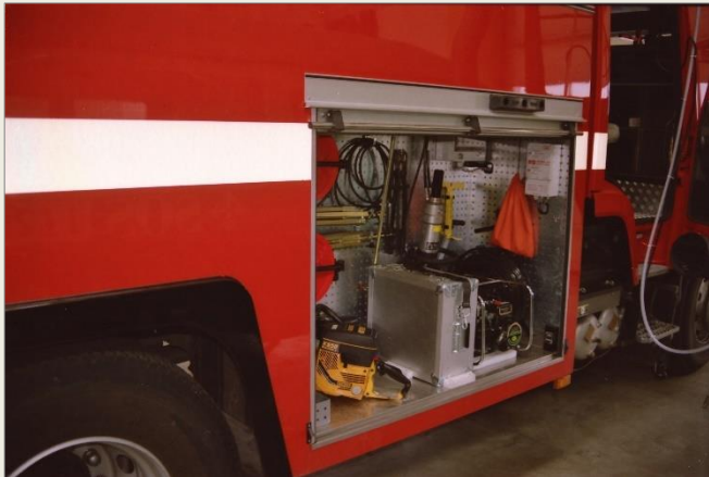
I facket på skåpets högra sida finns eldriven hydraulpump och olika verktyg.
