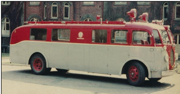
Första färdtjänstbussen, som även var ledningsbuss, nr 37. Volvo B20 brandbuss -39, ombyggd till katastrofbuss och ledningsbuss i början av 50-talet. M598. Larmutrustad. Ur Malmö Brandkårs bildarkiv
